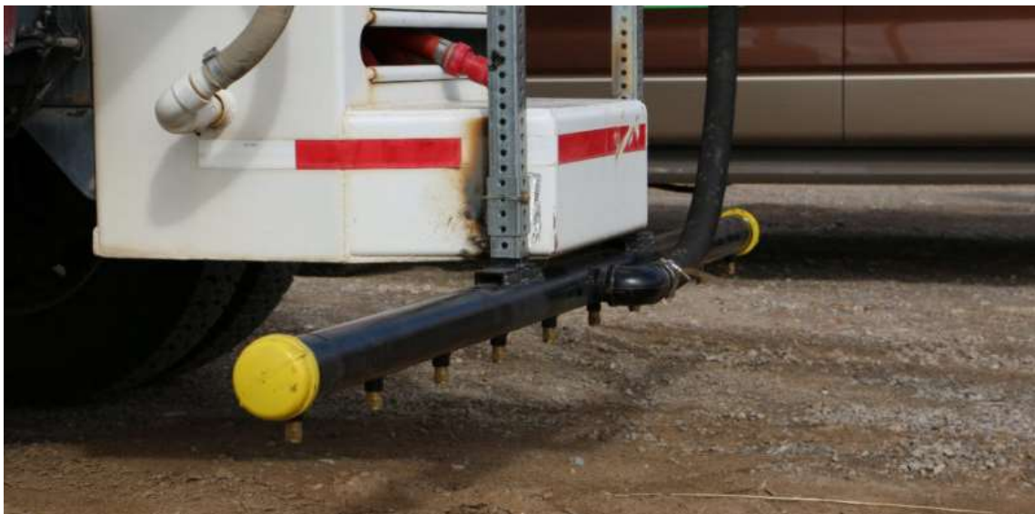
BARRA ROCIADORA PARA CAMIÓN CISTERNA DE 8' A 12' DE ANCHO CON SOPORTES Y ADAPTADORES
